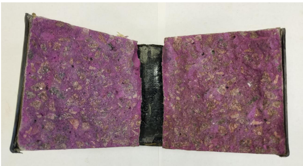
Рисунок 5 – Внешний вид бетонных образцов с системой покрытия ОСПТ «Reline» после 14 суток испытаний
