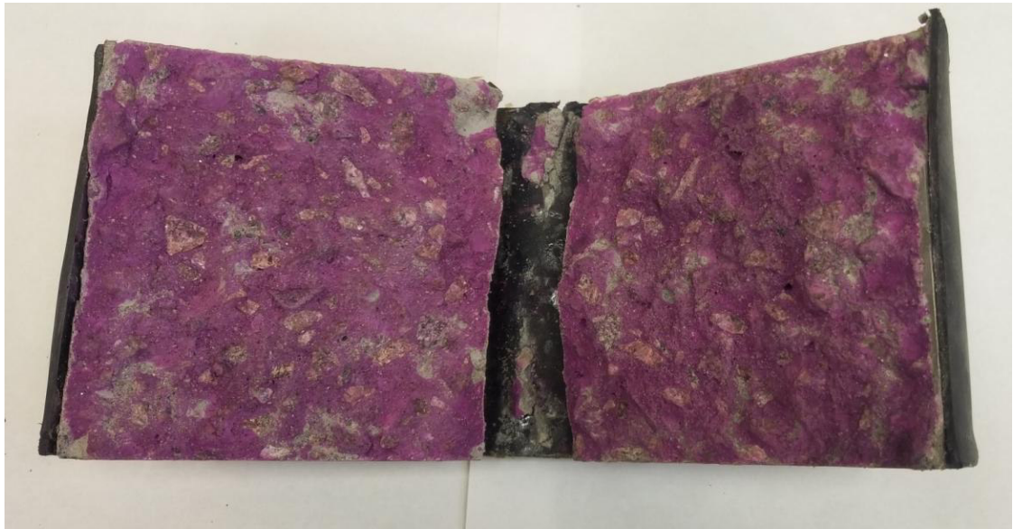
Рисунок 3 – Внешний вид бетонных образцов с системой покрытия на основе ОСПТ «Reline» после 7 суток испытаний
