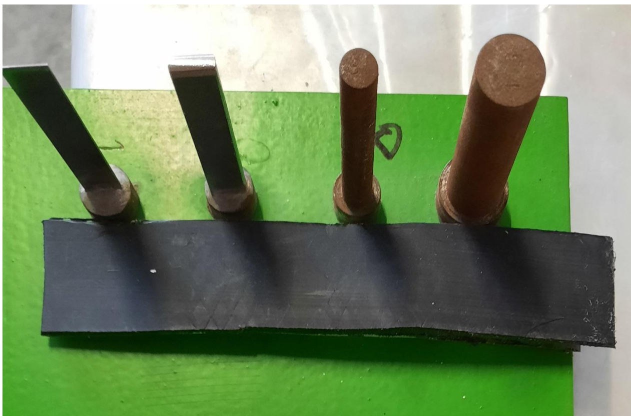
Рисунок 17 – Внешний вид образцов с системой покрытия ОСПТ «Reline» для определения прочности при изгибе
