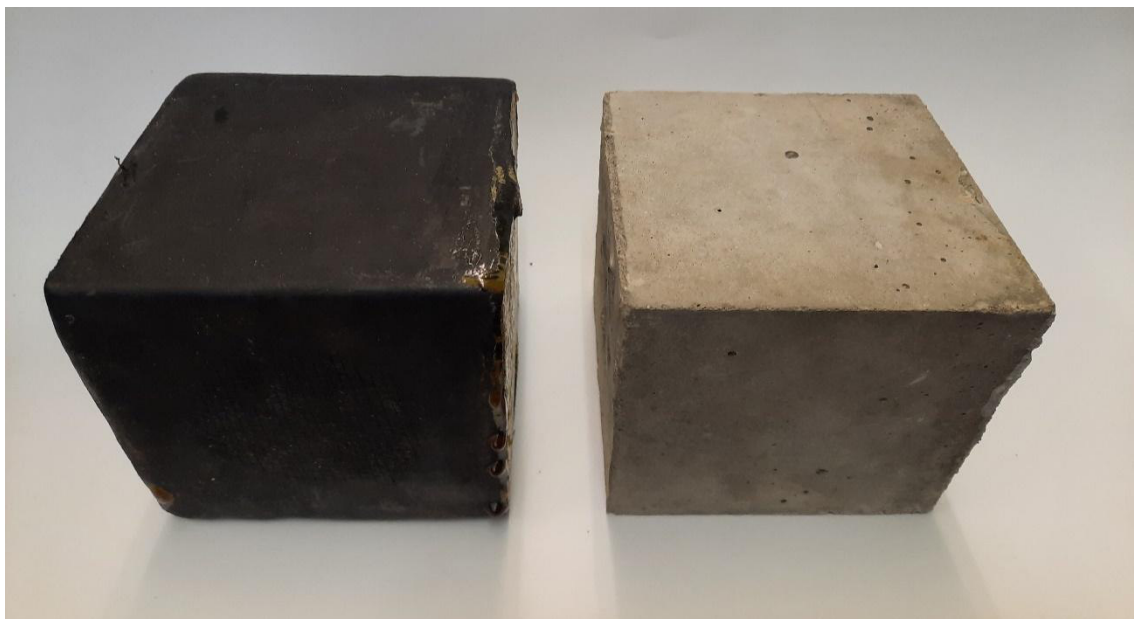
Рисунок 9 – Внешний вид образцов перед испытаниями на морозостойкость
