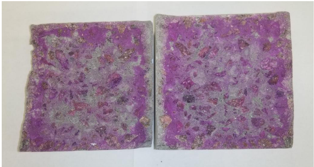
Рисунок 4 – Внешний вид контрольных бетонных образцов (без покрытия) после 7 суток испытаний
